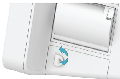
3. Ruotare il dispositivo di blocco lateralmente.
