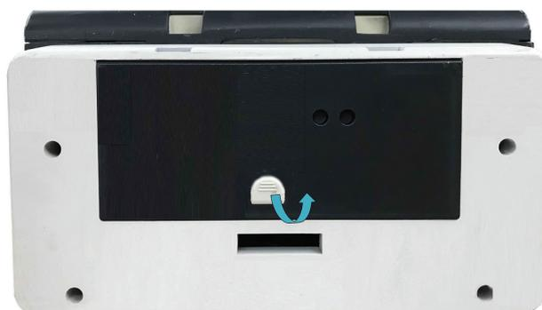
4. Inserite la batteria all'interno del vano delle batterie. Spingere la batteria verso il basso fino a quando il terminale della batteria si sarà inserito nel connettore della batteria.
